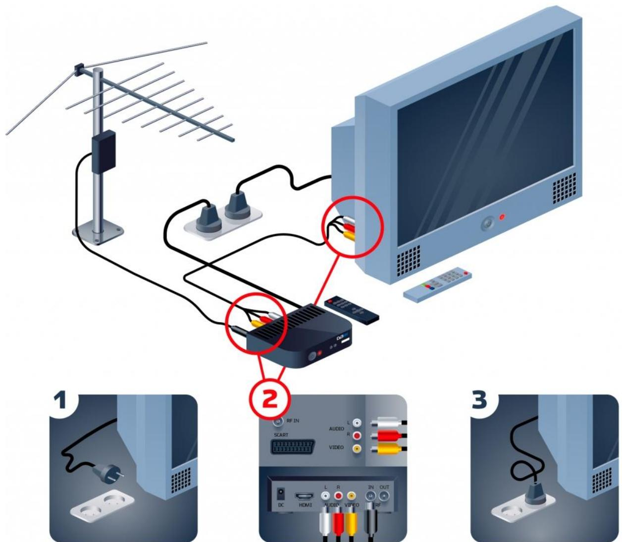
Для настройки просмотра телевизионных каналов аналогового формата необходимо дополнительным antennным кабелем, имеющим соответствующие PK-разъемы, соединить разъем (RF OUT) цифрового ресивера с разъемом (ANT IN) телевизионного приемника.
