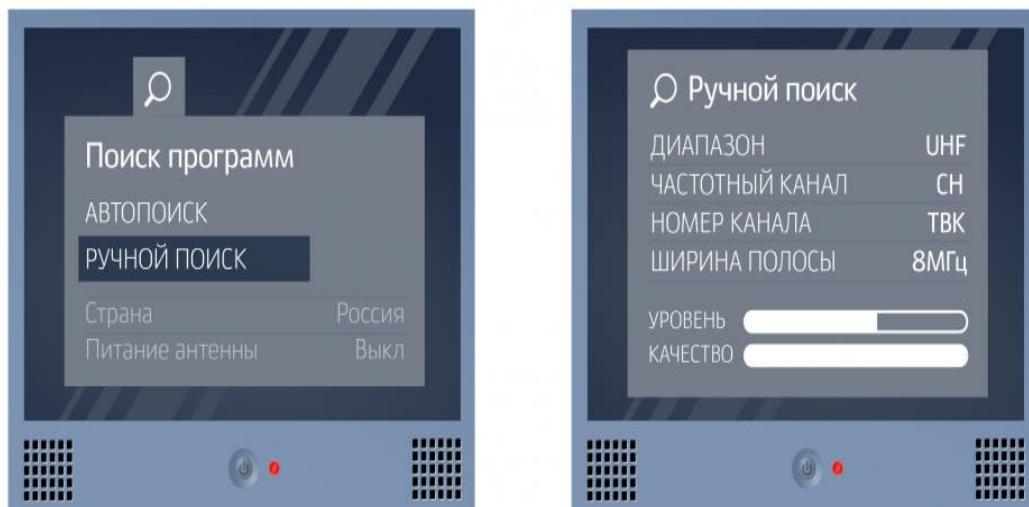
В меню перейдите к разделу настройка каналов. Выберите «Ручной поиск» - необходимо ввести номер канала или частоту. Введите: Диапазон — UHF; Частотный канал — СН; Номер телевизионного канала (ТВК); Ширина полосы (или полоса пропуска) — 8 МГц.
